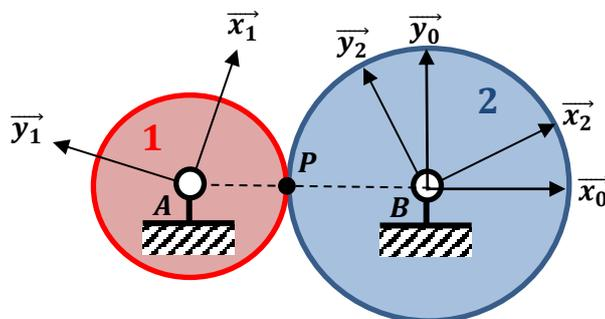
$$\|\overline{AP}\| = R_1 \quad ; \quad \|\overline{PB}\| = R_2$$
